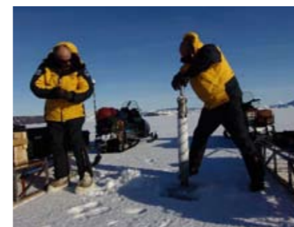
Extracción de testigo de hielo (Dirección Nacional del Antártico)
